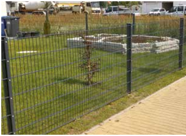
Doppelstabmatte 6/5/6 verzinkter Draht, anthrazit, Maschenweite 50x200 mm, Zaunfeld 1.630x2.510 mm
