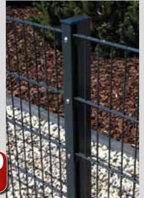
Pfosten PCK , verzinkt, anthrazit, mit Abdeckleiste 40x5 mm, Bohrbild 20 cm, zum Einbetonieren. 60x40x 2.400 mm
