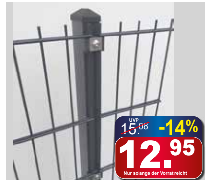
DS Pfosten Light , anthrazit, Bodeneinstand: 600 mm, für Zaunhöhe 1.430 mm, Zaunbauschraube A2, M8 x 40 mm, Innensechskant SW 5,5 mm, Kunststoffkappe schwarz. 60x40x1.800 mm
