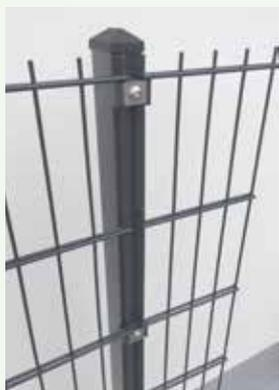
**DS Pfosten Light**, anthrazit, Bodeneinstand: 600 mm, für Zaunhöhe 1.430 mm, Zaunbau-schraube A2, M8 x 40 mm, Innensechskant SW 5,5 mm, Kunststoffkappe schwarz.
